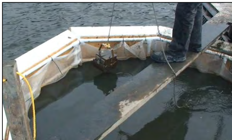
Figure III-13 Benne à sédiments d'échantillonnage utilisée pour le dragage mécanique
