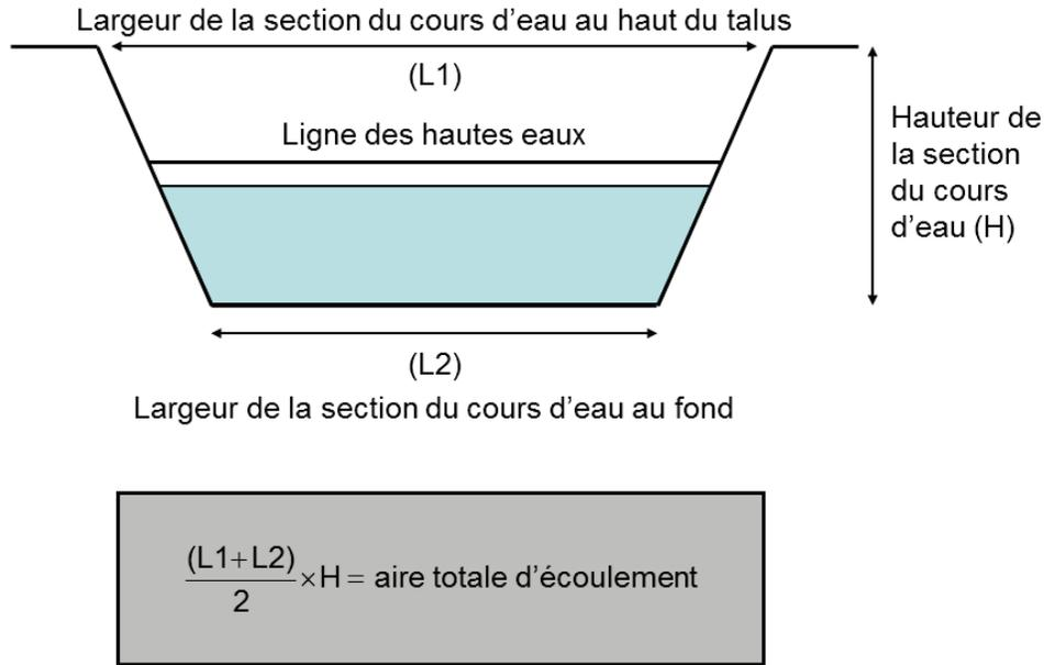
Figure 3 : L'aire totale d'écoulement d'un cours d'eau
