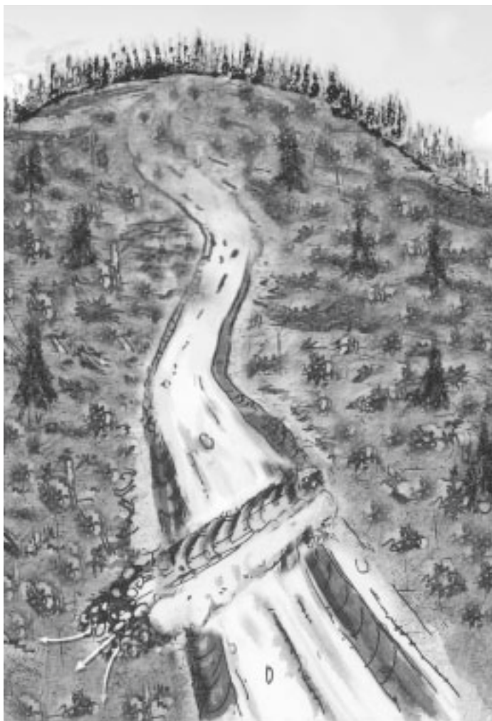
Figure 3.2 - Digue de déviation
