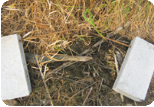
Figure 58 : Ancre formé d'une tige de métal et de blocs de ciment
