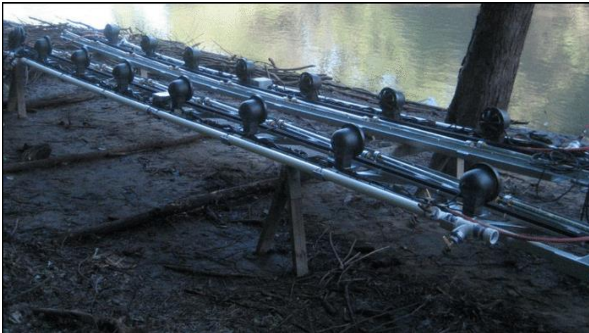
Figure 5.7 Barrière intégrée (lumières-bulles-sons) avant l'installation (Ruebush et coll., 2011).
