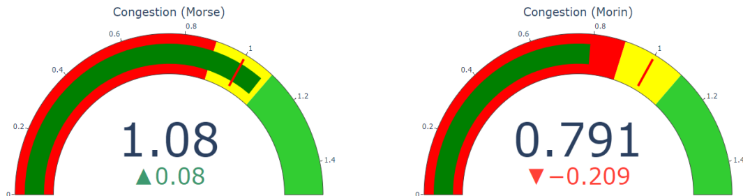
Figure 60: Capture d'écran de l'outil : Indicateur comparant du débit de glace et de la capacité d'évacuation selon les modèles de vitesse de la glace et le secteur.
