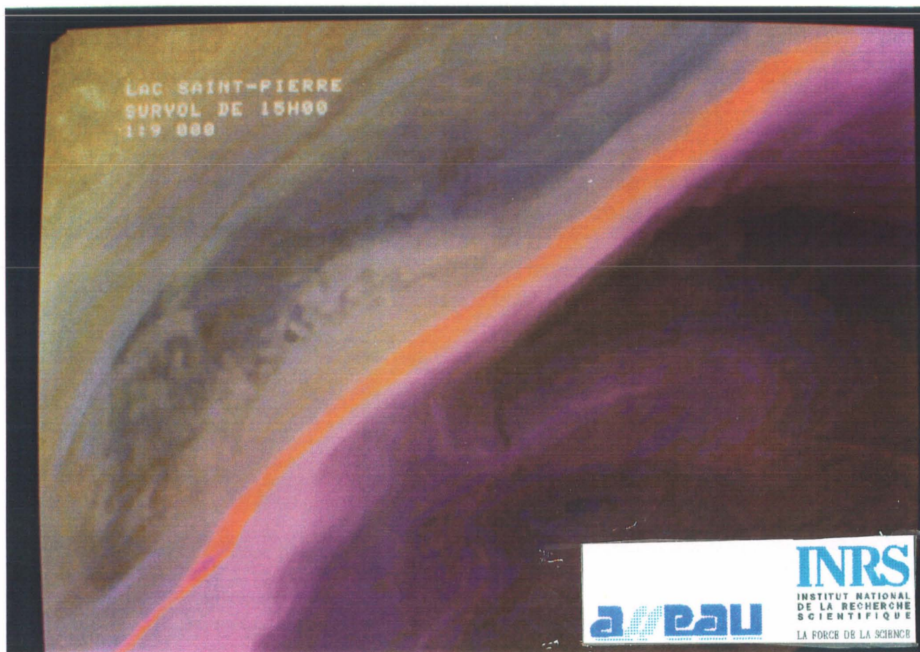
Figure A4-1 Rehaussement par décorrélation des bandes MEIS-4/7/5 - Image du lac Saint-Pierre - Survol de 15h00
