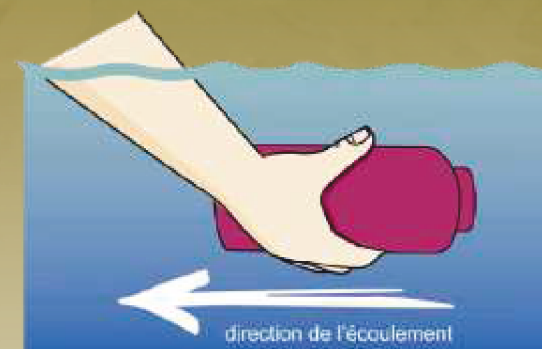
Figure 1- 1 : Le remplissage du flacon doit se faire dans le sens d'écoulement de l'eau (Le réseau d'évaluation et de surveillance écologique (RESE Nord), 2005)
