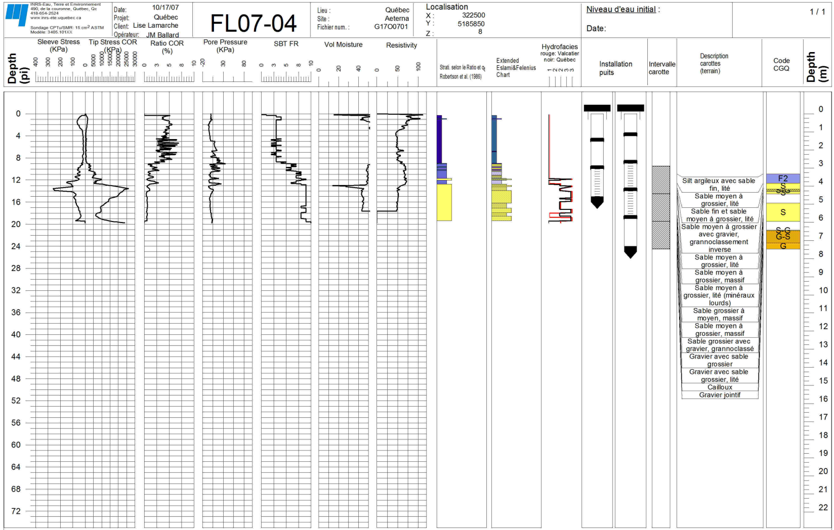
Figure 2.17 Sondage au piézocône (CPT) au site de Aeterna (FL07-04)
