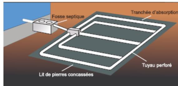
Figure 2. Composantes d'un réseau de fosse septique
