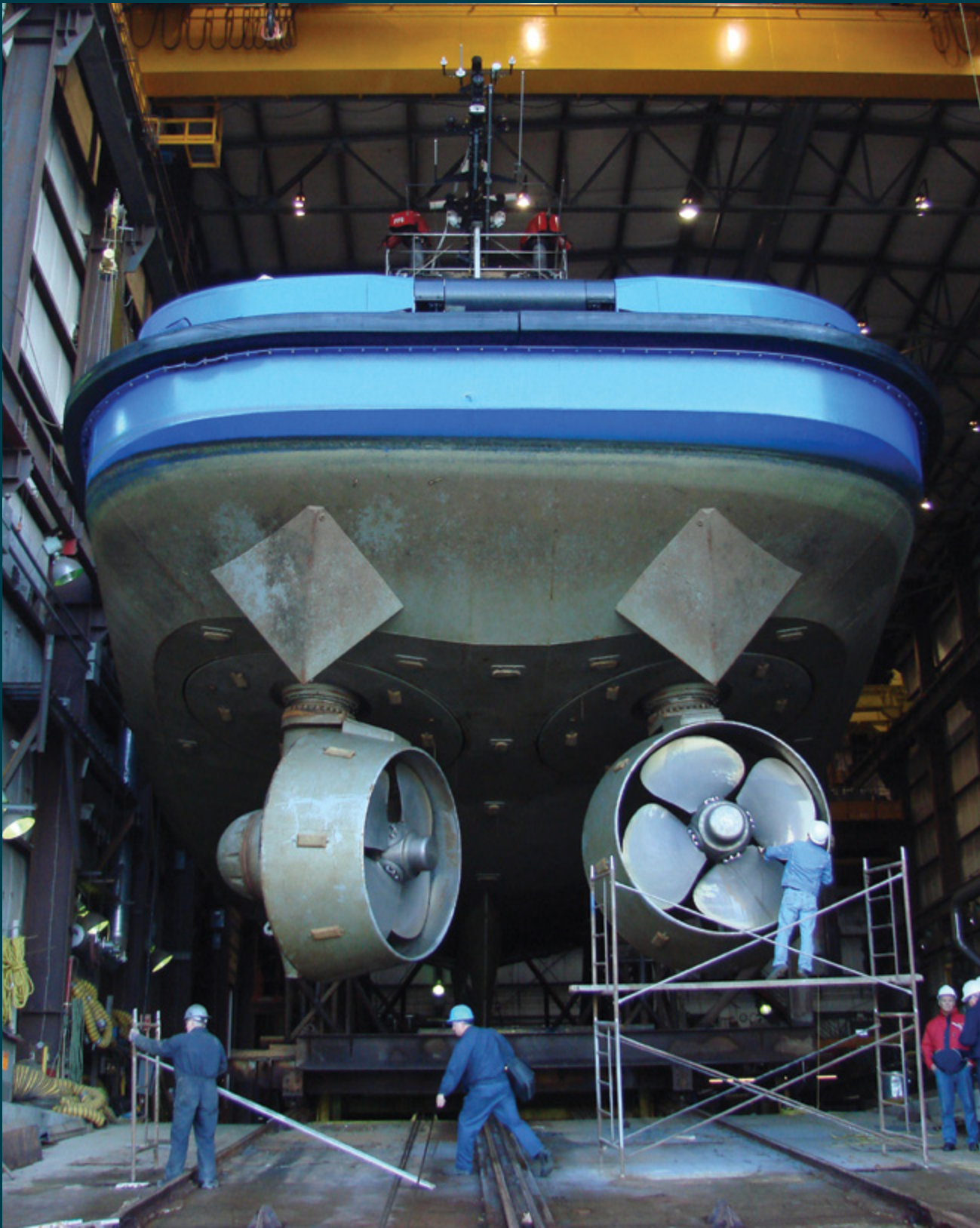
Photo : Sodes – Groupe Océan, Z-drive repair
