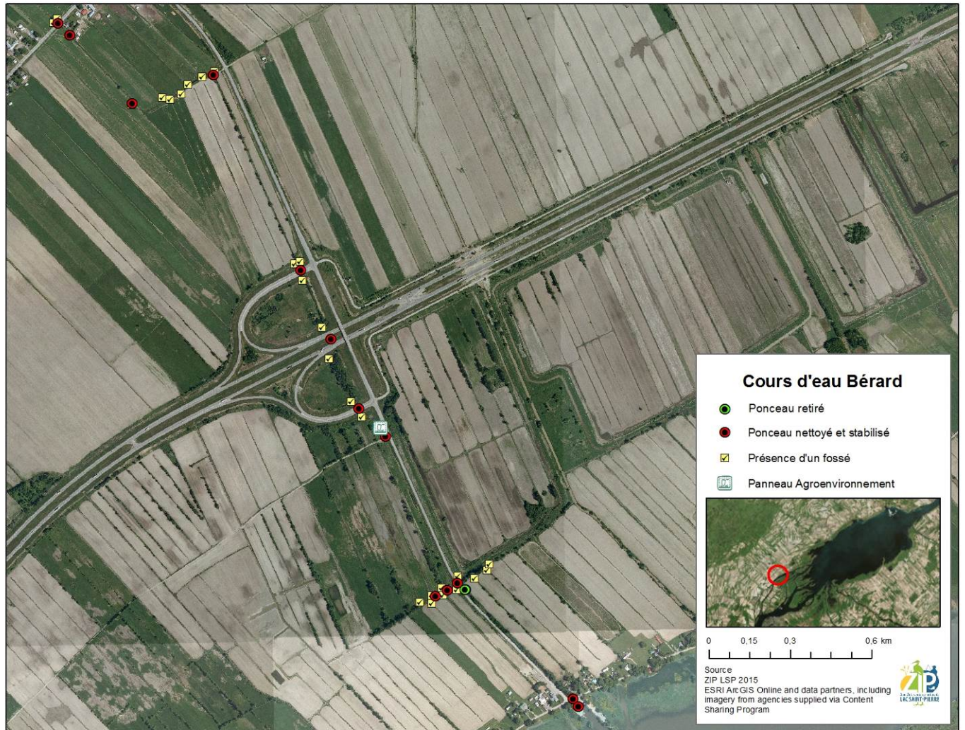
FIGURE 10 EMPLACEMENT DES PONCEAUX INDIQUÉS PAR DES CERCLES POINTÉS
