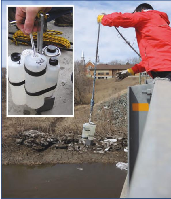
Prélèvement d'échantillons à partir d'un pont
