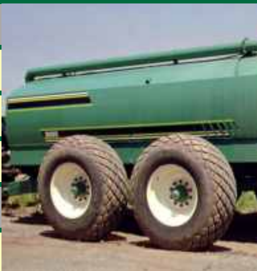
Pneus réduisant la pression au sol et roues jumelées
