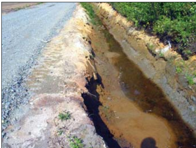
Photo 3 : Phénomène de boulangerie suite au creusement d'un cours dans un sol avec une nappe élevée Source : Victor Savoie, MAPAQ
