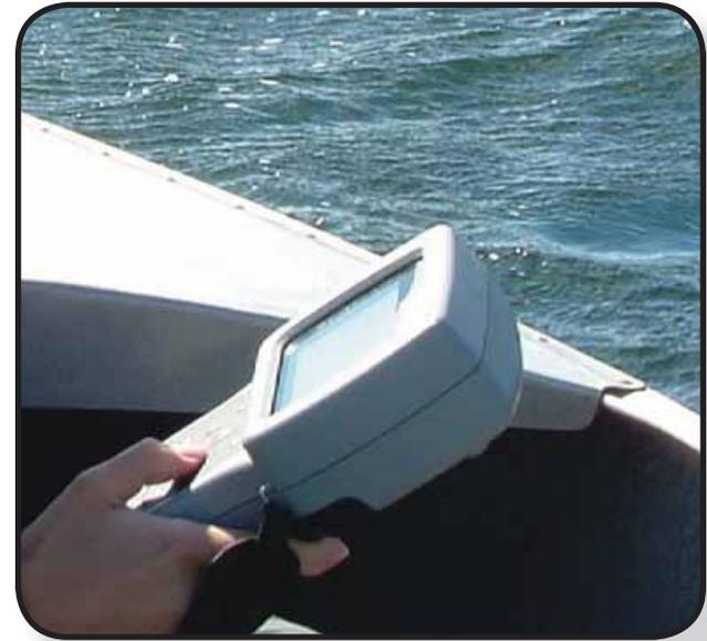
On mesure la conductivité de l'eau à l'aide d'une sonde. L'utilisation d'une sonde permet de mesurer d'autres variables (si elle est équipée des capteurs appropriés) tels que la température, l'oxygène dissous, le pH et la profondeur.
