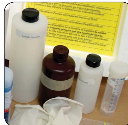
Voici les bouteilles contenues dans votre trousse d'échantillonnage. La bouteille brune est utilisée pour l'analyse de la chl<sub>a</sub> tandis que les deux autres petites bouteilles servent respectivement à la détermination du COD et du PTtra.
