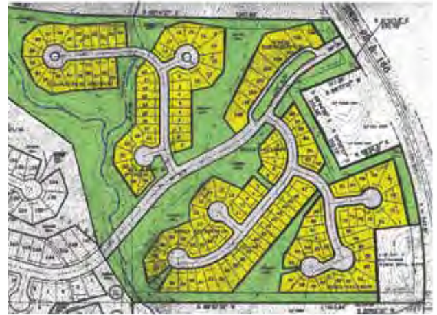
Figure 4.10 Exemple d'aménagement avec des pentes naturelles fortes.
