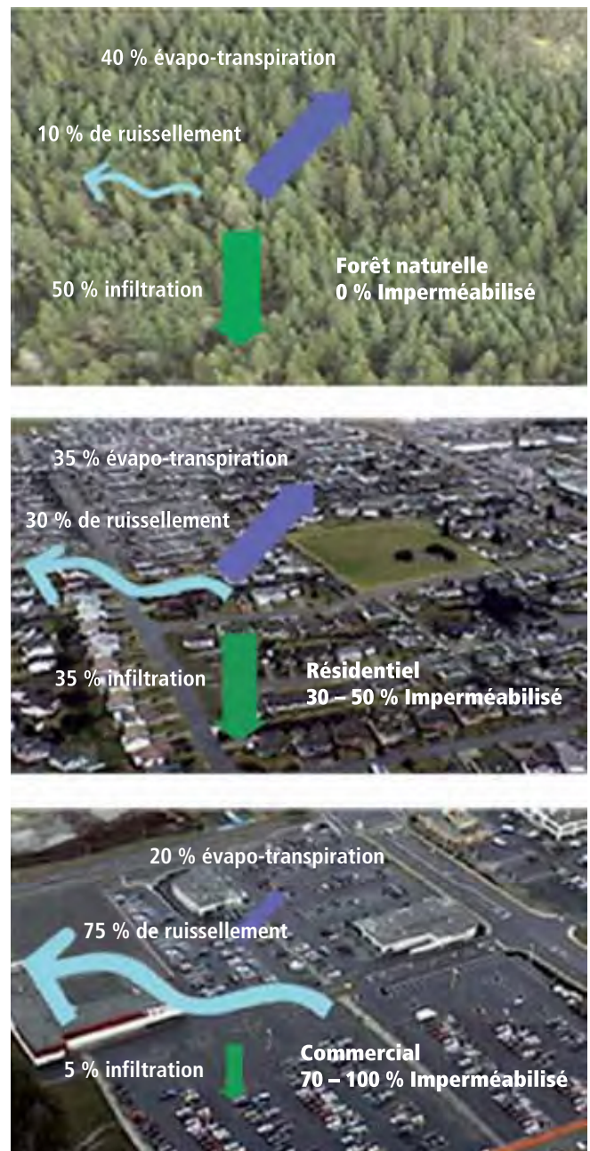
Figure 2.6 Modifications aux paramètres hydrologiques dues à l’urbanisation (adapté de Stephens, 2002).
