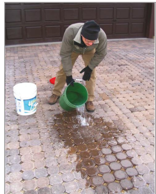
Pavé préfabriqué perméable démonstration
