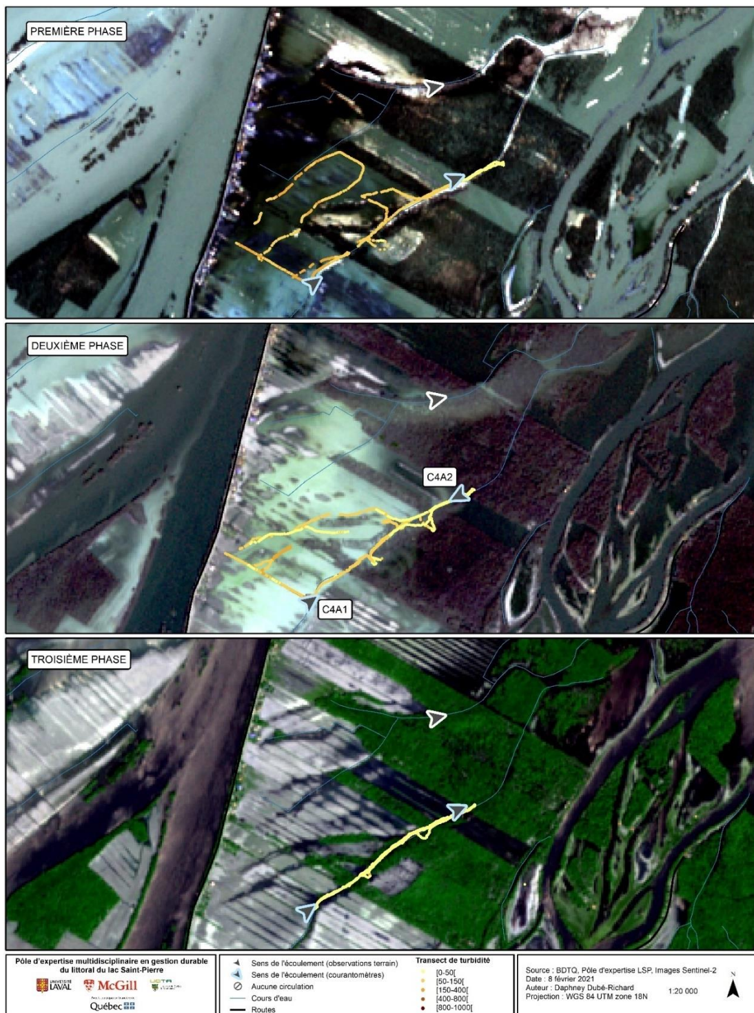
Figure I12. Patrons d'écoulement de l'eau et turbidité dans le littoral au cours des trois phases de la crue à l'île Dupas. Les flèches indiquent le sens de l'écoulement mesuré par les courantomètres (bleues) ou observées sur le terrain (blanches). Les lignes indiquent les parcours effectués en kayak et la turbidité mesurée, de faible (jaune) à élevée (orange). Les étiquettes indiquent l'emplacement des courantomètres (ex. : C4A1). Les fonds de carte sont les images Sentinel-2 dont les dates correspondent aux trois phases de la crue, en 2019 (haut), 2020 et 2021 (bas).
