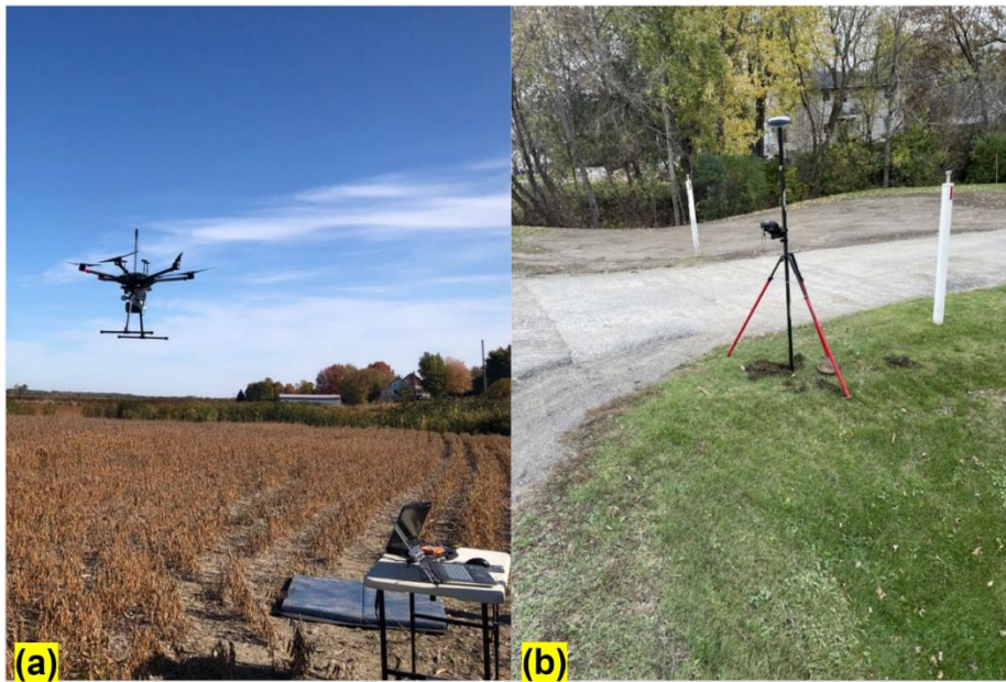
Figure G3. Capteur LiDAR et sa plateforme de drone (a), configuration de la station de base GNSS (b).
