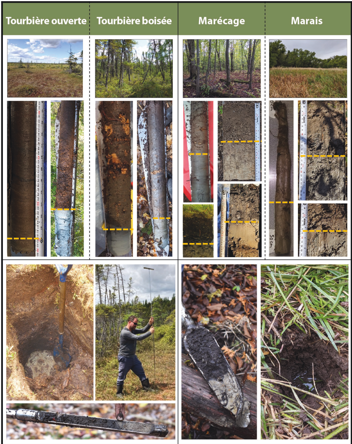
Figure 6. Mesure de l'épaisseur d'un dépôt organique dans différents types de milieux humides. Les lignes tiretées orange représentent la zone de contact entre le dépôt organique et le dépôt minéral.
