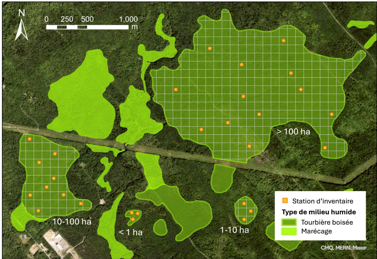
Figure 4. Exemples de stratégies d'inventaire des masses de carbone visant à quantifier le stock de carbone dans des milieux humides de différentes superficies. Les stations sont placées aléatoirement à l'intérieur de chaque carré de la grille.
