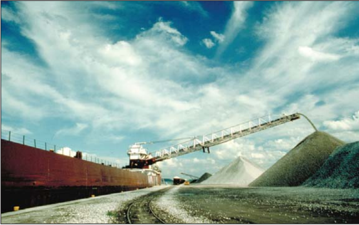
Laquier auto-déchargeant transportant du calcaire Source : U.S. Army Corps of Engineers
