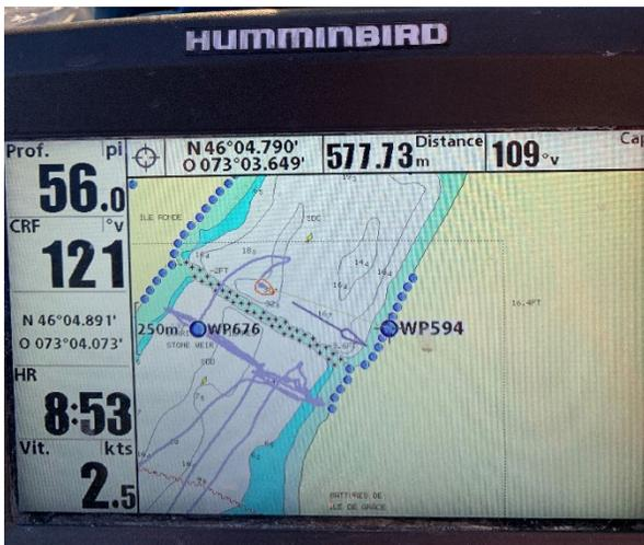
Photo 13 Profondeur (56 pi ou 17,1 m) et vitesse d'écoulement (2,5 nœuds ou 1,3 m/s) mesurées à l'endroit du reversoir 2
