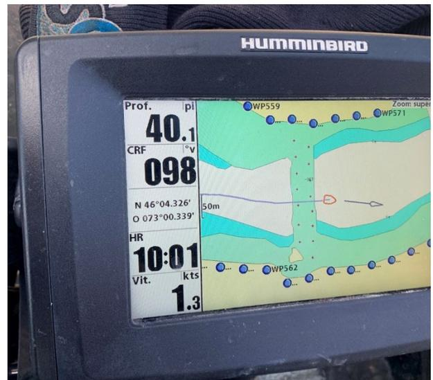
Photo 14 Profondeur (40,1 pi ou 12,2 m) et vitesse d'écoulement (1,3 nœud ou 0,7 m/s) mesurées à l'endroit du reversoir 1
