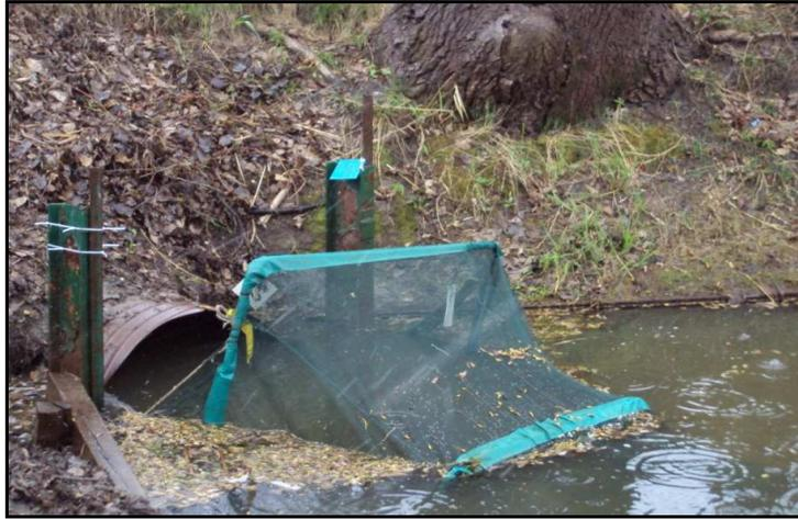
Photo 3. Filet-trappe de type Alaska installé en amont de la voie migratoire pour capturer les poissons en montaison du 7 au 9 avril et du 26 avril au 10 mai 2010 au marais de l'Île du Milieu.
