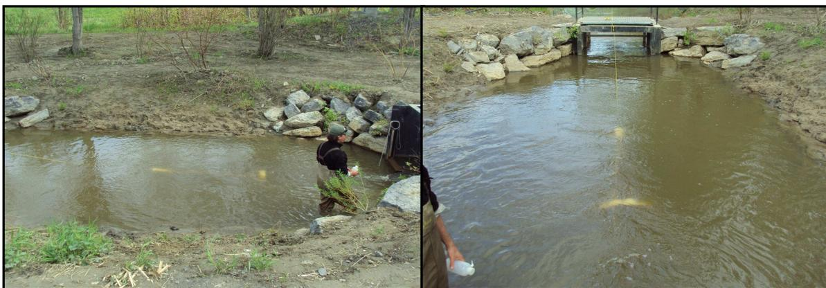
Photo 8. Filet de dérive utilisé pour l'échantillonnage des larves en dévalaison au marais de l'Île du Milieu.
