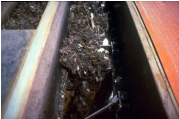
Résidus de grilles récupérés après le dégrillage
