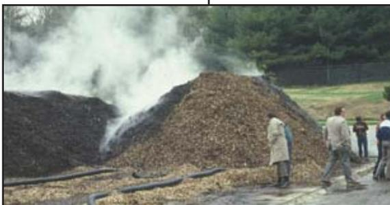
Piles statiques sous aération forcée
